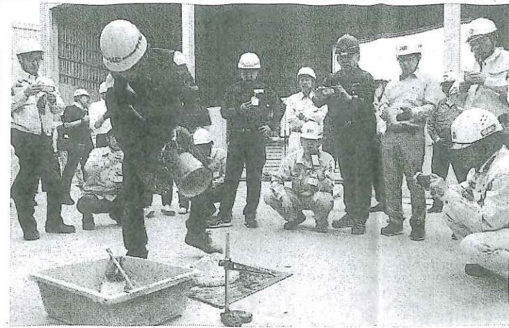
スランプ測定で性状を確認
