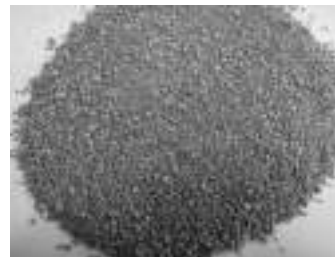
写真 4 再生粗骨材(吸水率=3.0%, 絶乾密度=2.5 kg/l)
