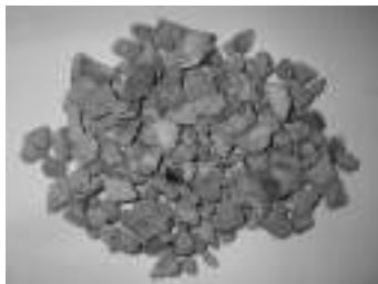
写真 3 再生粗骨材(吸水率=1.6%, 絶乾密度=2.6 kg/l)
