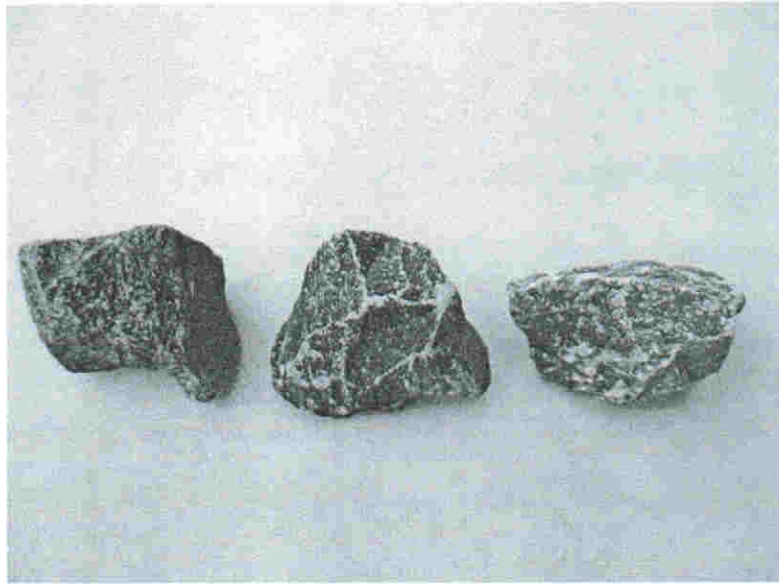
รูปที่ ง.3 รูปร่างอนุภาค : เป็นเหลี่ยม (ข้อ ง.3.2)
