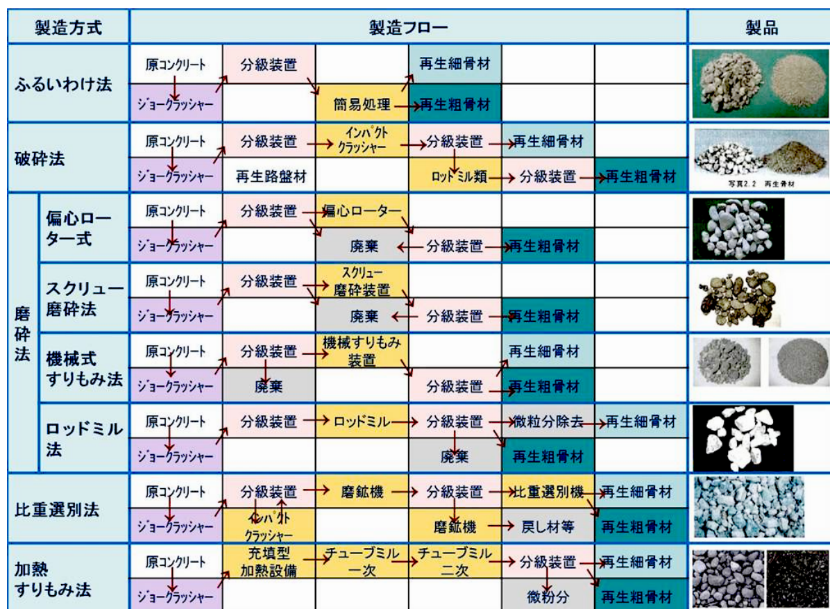
図5 「コンクリート用再生骨材」の製法（反復ルートは省略。）
